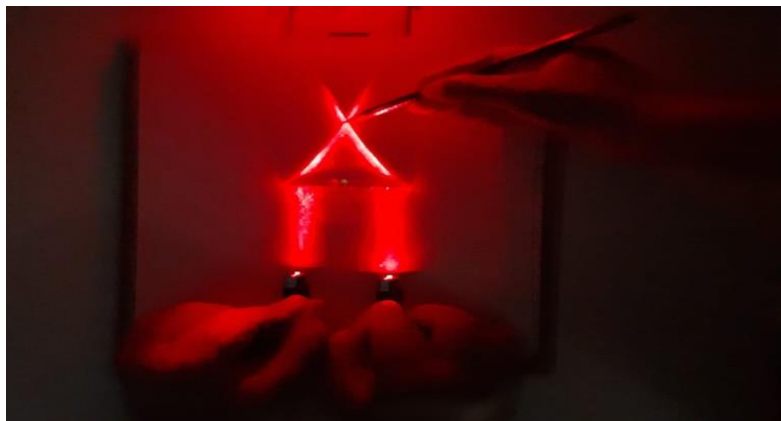
Figura 29: Estudante marcando o ponto focal da lente no papel milimetrado
