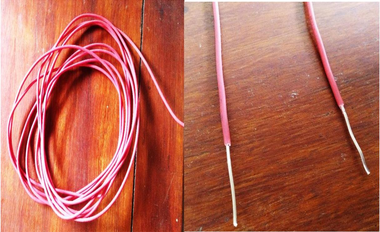
Figura 3.2: Fio de 6 mm.
