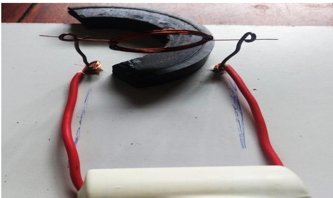
Figura 3.11: Motor elétrico.
