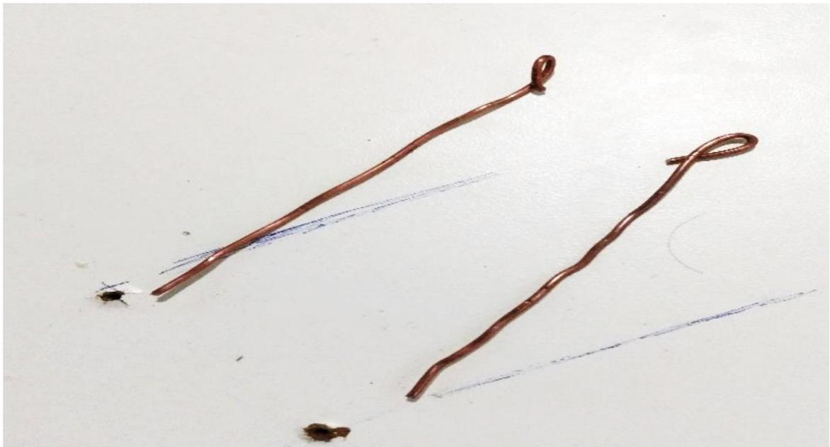
Figura 3.3: Fio rígido desencapado com uma alça.
