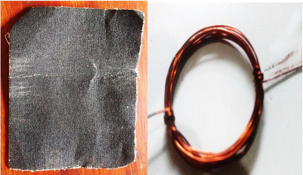
Figura 3.7: Lixa e fio da bobina sem esmalte.
