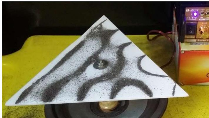
Figura 04 – Experimento realizado numa placa triangular de acrílico.
