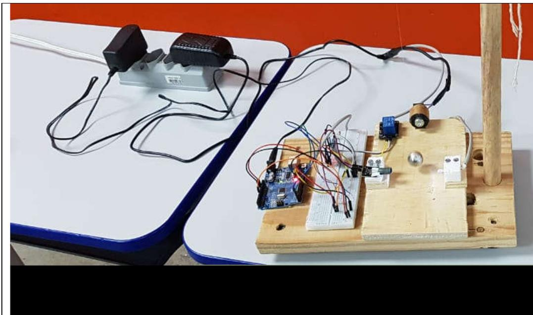
Figura: Dispositivo de medição do período do pêndulo
