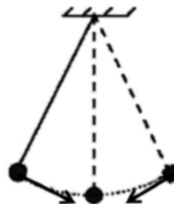
Pêndulo em movimento oscilatório em torno da posição de equilíbrio
