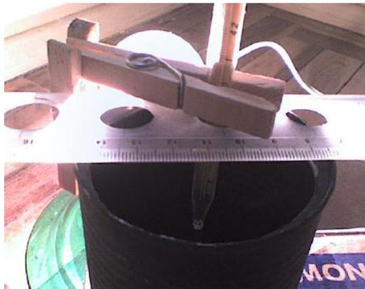
Figura 2: suporte do termômetro
