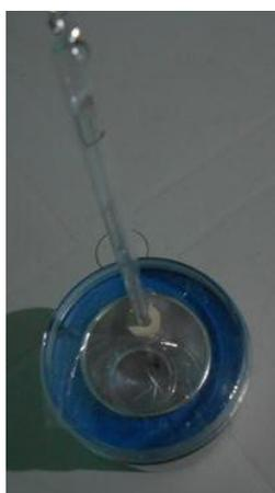
**Figura 1:** Calorímetro com termômetro analógico.
